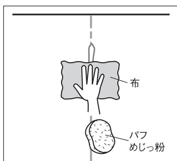
ジョイントの隙の大きさ、状態により施工手順を変える。
