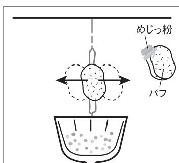
粉を、布・パフ（硬めのもの）等に付着させ、左右に撫でる。あるいは、たたくように隙に充填する。その場合ジョイント左右にあまり広がらないよう注意すること。
